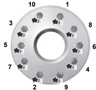
10-lug nut torque sequence
